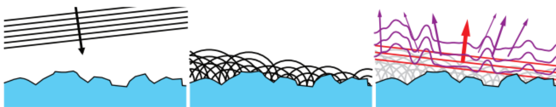
图 9.45：左图：我们可以看到入射到粗糙纳米几何表面的平面波前。中间：我们可以看到表面上的球面波是根据 Huygens–Fresnel 原理形成的。右图：我们可以看到在发生相长干涉和相消干涉之后，产生的一些波（红色部分）形成了一个平面反射波。剩下的部分（紫色部分）则发生了衍射，每个方向上光的传播量都不同，这取决于光的波长。
