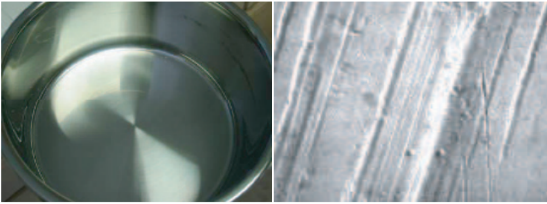
图 9.26：左边是一个各向异性的表面（拉丝金属），请注意反射的定向模糊。右图是一个相似表面的显微照片，请注意表面细节的方向性。
